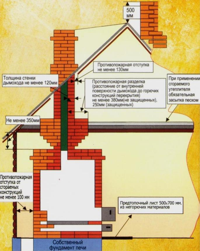
между стенками печи и деревянными конструкциями должен оставаться воздушный промежуток - отступка печь и дымовая труба в местах соединения с деревянными перекрытиями должны иметь утолщени<sup>е</sup> кирпичной кладки - разделку, чтобы своевременно обнаружить появление трещин, дымоход должен быть побелен. Не реже одного раза в месяц дымоход необходимо очищать от сажи.
